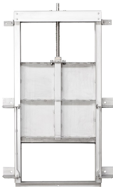
Obr. 1 – Vřetenové šoupátko XL4 pro kruhové nebo pravoúhlé otvory, 4-stranně těsnící, velikost 100 x 100 mm až 4000 x 4000 mm
