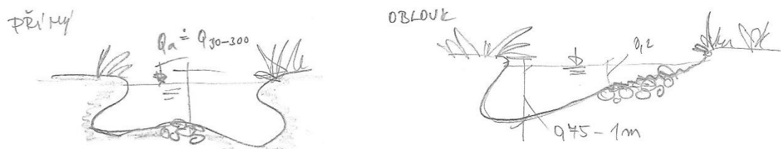
obr. 11 - Vzorový řez revitalizovaným korytem v přímé trati a v oblouku
