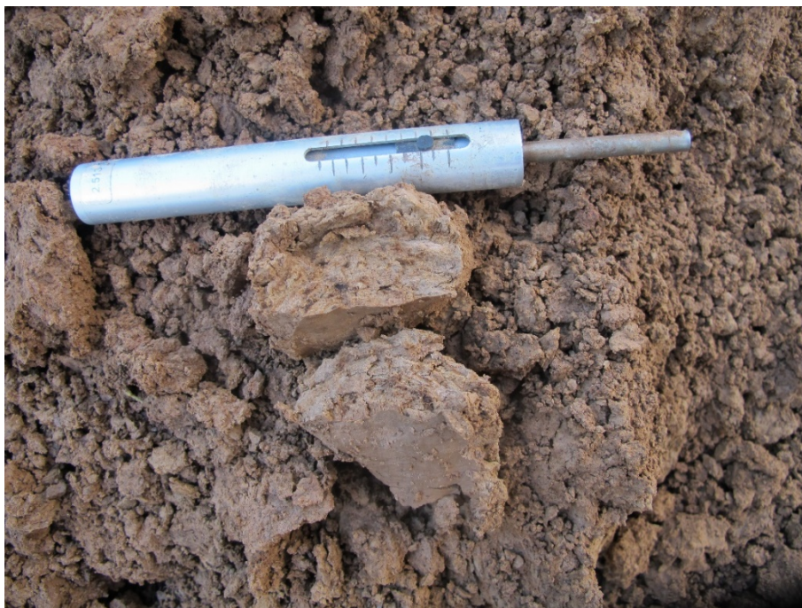
Obr. 5. Charakter jílu s nízkou plasticitou z kopané sondy KSH.
