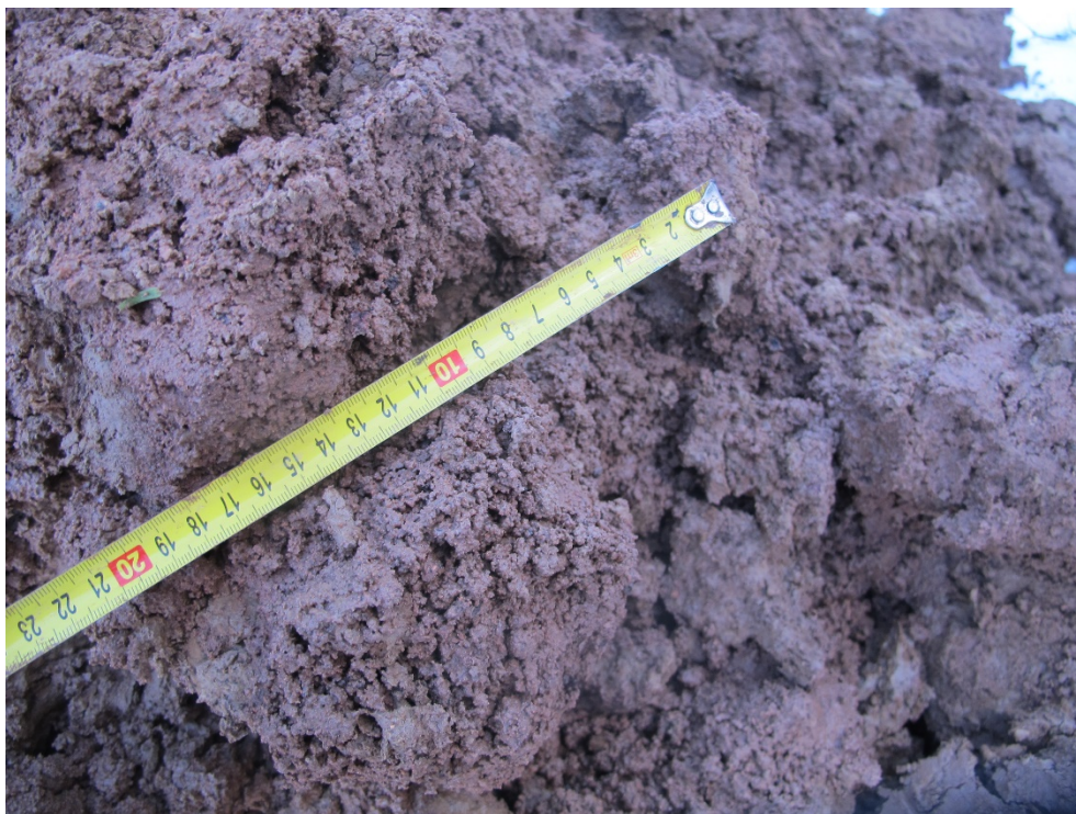
Obr. 4. Charakter jílu s nízkou plasticitou z kopané sondy KSZ.
